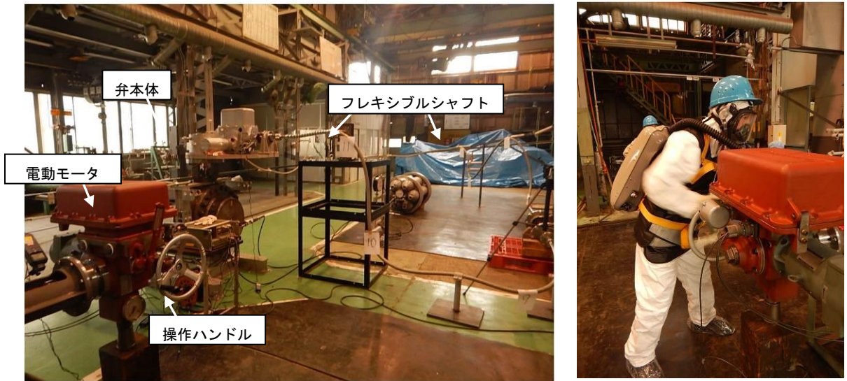
図6 モックアップ試験概略
