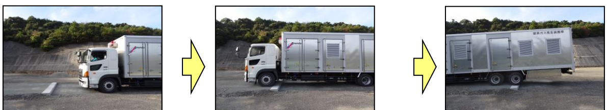
第2図 段差復旧前の走行性能検証(1/2)
