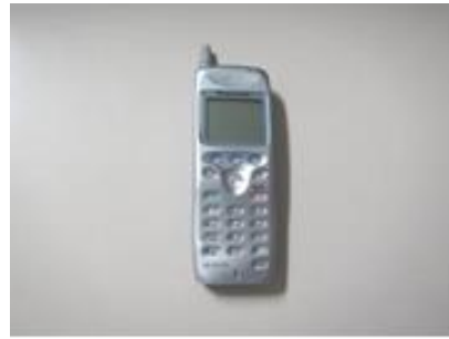
電力保安通信用電話設備 (PHS 端末)
