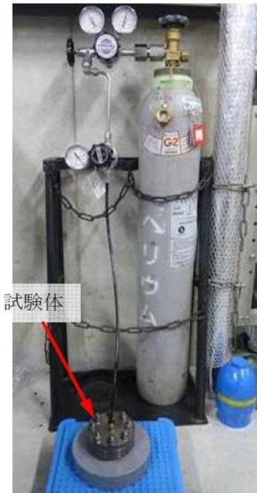
図5 He気密確認試験状況
