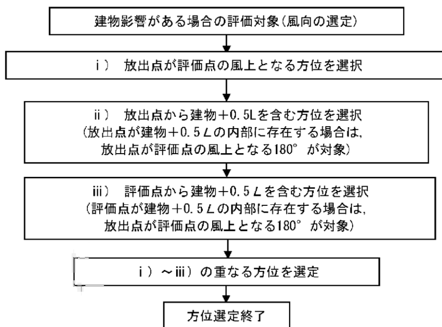
第4図 建物の影響がある場合の評価対象方位の選定手順 (被ばく評価手法(内規)図5.7)
