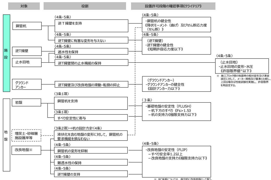
第9-2 図 設置許可段階における確認項目 [防波壁（逆T擁壁）]
