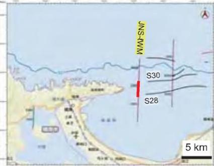
解釈結果のうち海底下約80m以浅については、原則として高分解能マルチチャンネル調査(ブーマー震源)の結果を転写した。 II-15
