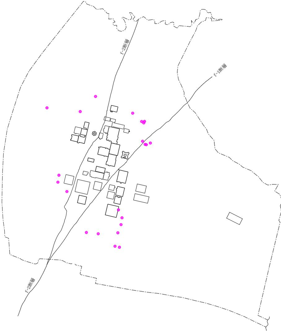
第 4.3-6 図 造成盛土の物性値の設定に用いたボーリング調査孔の位置図
