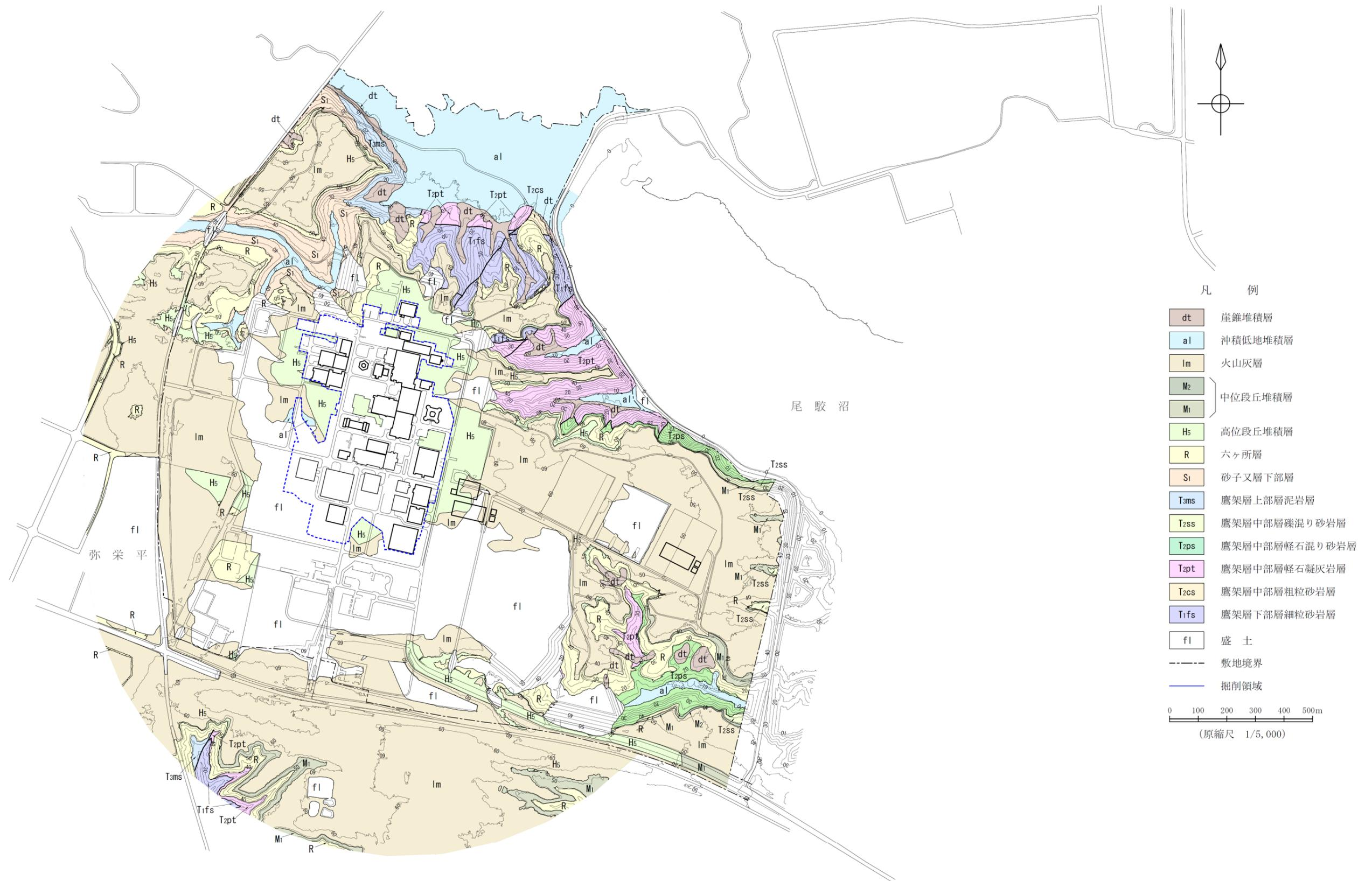
第 4.3-2 図 再処理事業所の地質平面図及び掘削範囲
