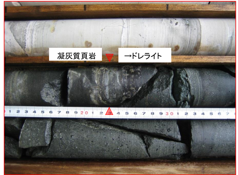
拡大写真 No.341 GL-203.23m 深部ドレライト境界部
