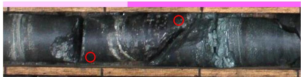
GL-203.10m 凝灰質頁岩 ドレライト GL-203.40m
