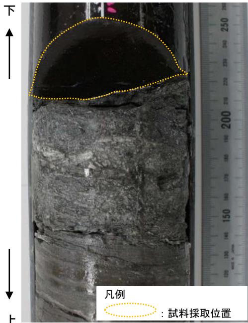
BS-2, B23シームの条線観察 試料採取位置 写真
