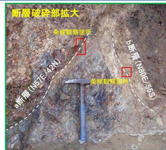
・断層露頭⑤と同様に、断層面に沿って安山岩が分布する。
