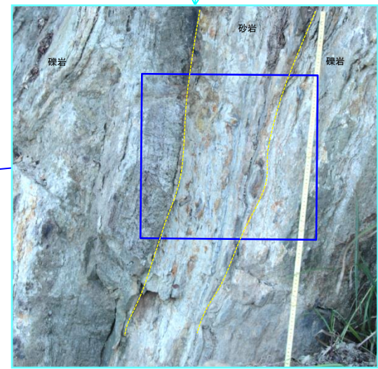
層厚約25cmの砂岩で泥岩を葉片状に挟み， 細かな亀裂が発達している。
