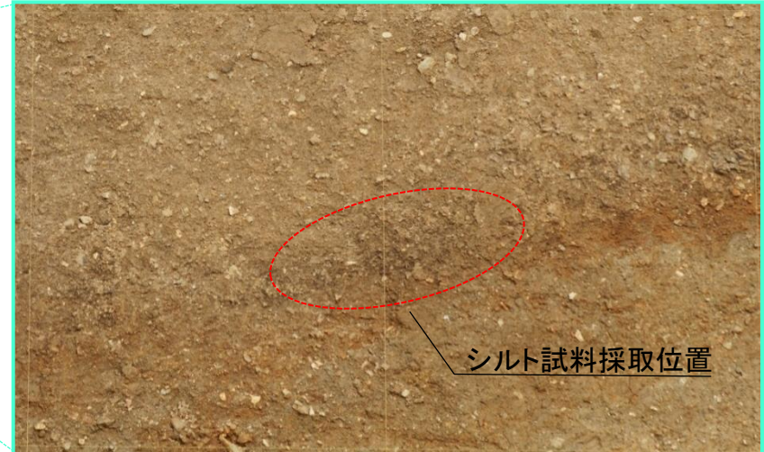
シルト試料例(崖錐堆積物2層より採取)
