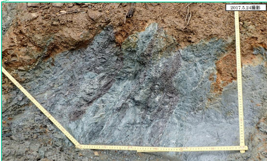
熱水変質部拡大(解釈線なし)
