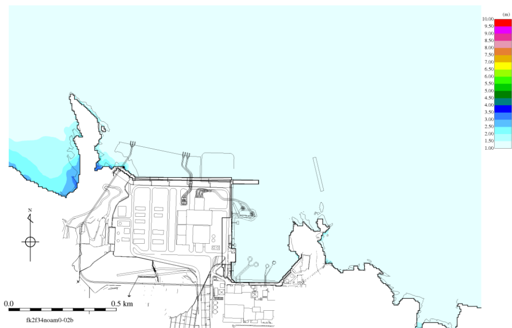
第1.5-5図(2) 海域活断層上昇側最大ケースの遡上波による最高水位分布 (防波堤有り)
