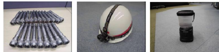
中央制御室における照明の確保 (例)
