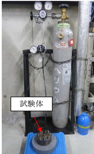
第 41 図 He 気密確認試験状況
