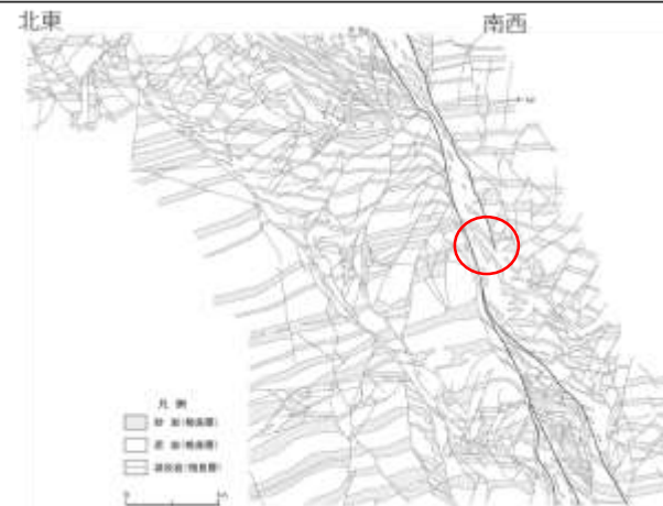
細粒物質を伴う断層が不明瞭なH断層の例 H-5断層 (GTG建屋南側法面(西面))
