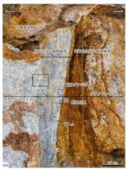
図 4 Y1近傍の断層面や断層破碎帯の写真
