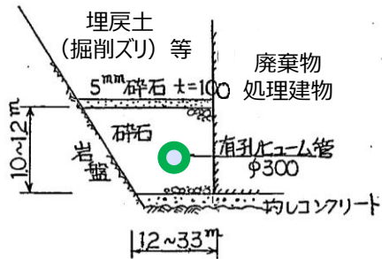
集水管 (タービン建物, 廃棄物処理建物周辺)
