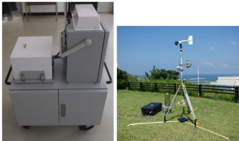
第 2.3.3-1 図 可搬型モニタリングポスト (左), 可搬型気象観測装置 (右)
