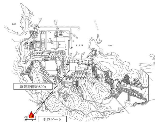
第 2-1 図 燃料輸送車両の離隔距離
