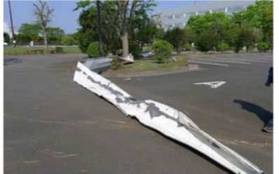
飛散した鋼板製屋根材
