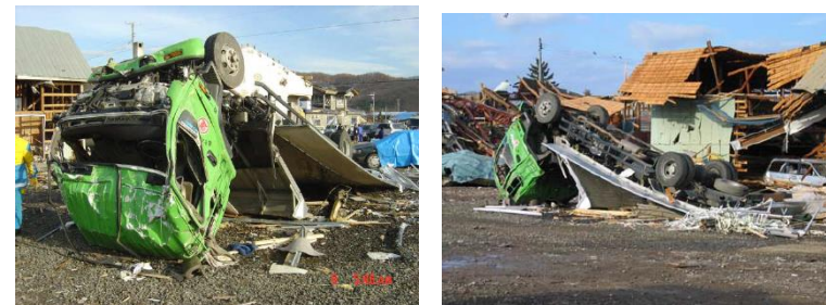
第6.3-4図 竜巻による被災後の4tトラックの様子 (xx) (xx i)
