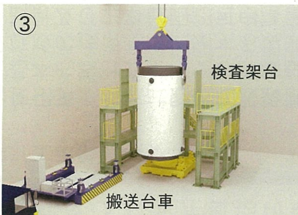
使用済燃料乾式貯蔵建屋内での乾式キャスク取り扱いイメージ図
