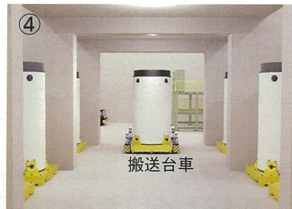
使用済燃料乾式貯蔵建屋内での乾式キャスク取り扱いイメージ図
