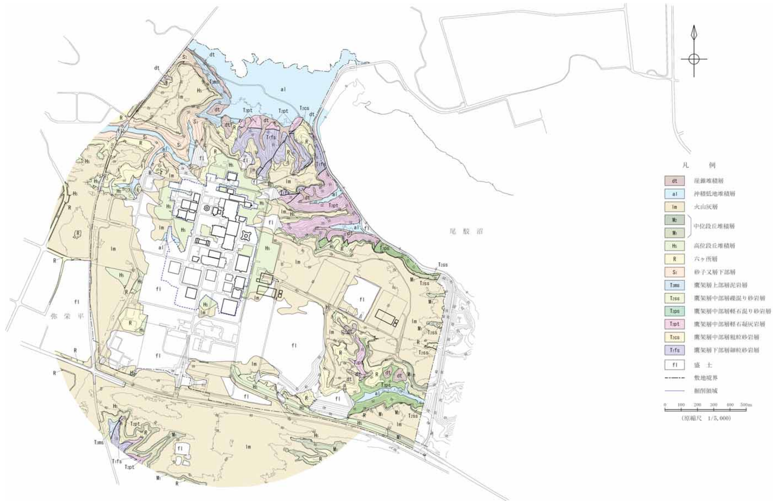
第 4.2-2 図 再処理事業所の地質平面図及び掘削範囲
