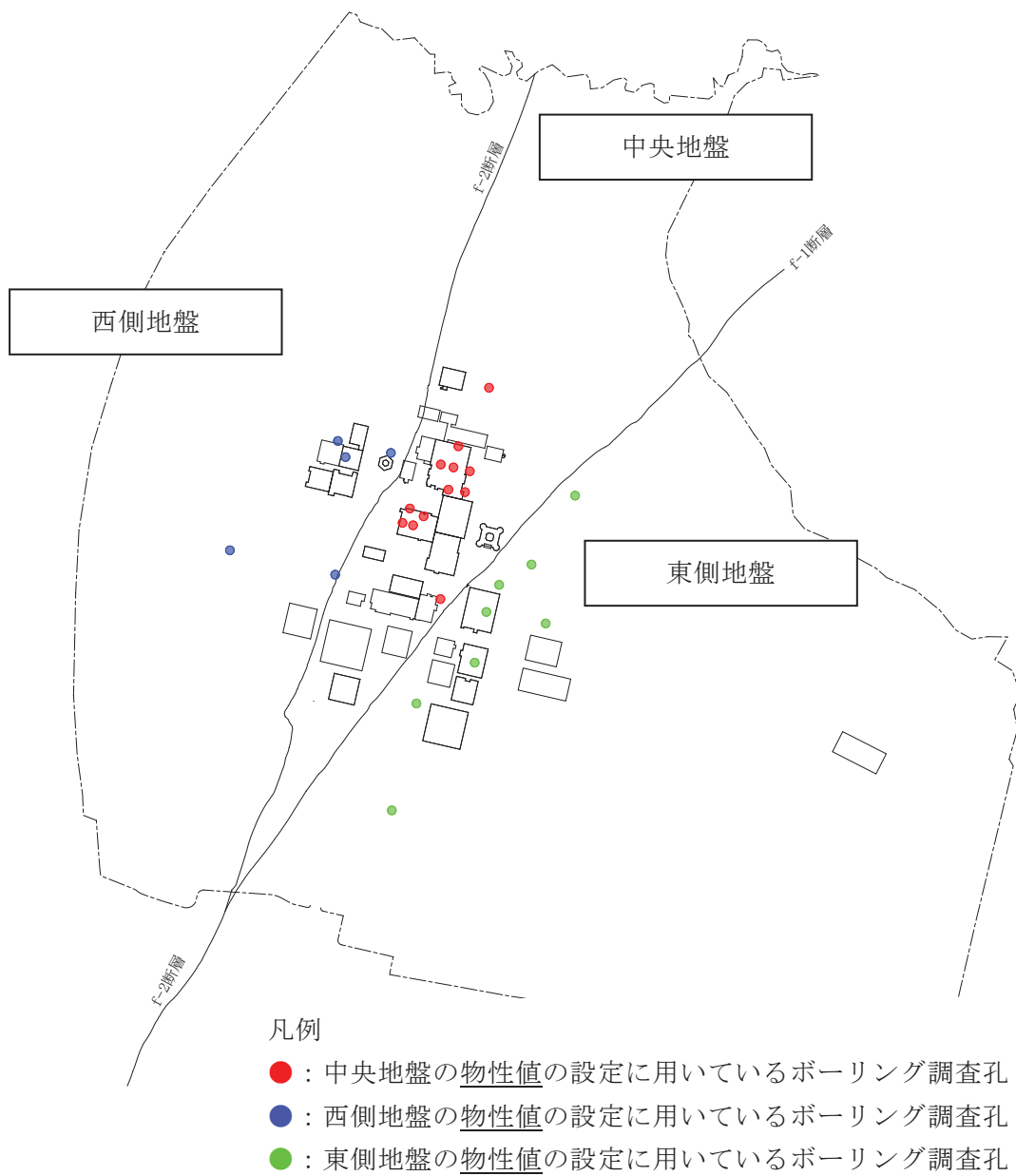
第 4.1-1 図 支持地盤の物性値の設定に用いたボーリング調査孔位置図
