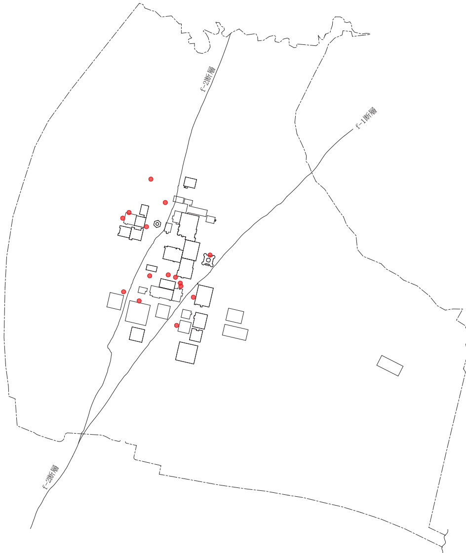
第 4. 2-3 図 埋戻し土の 物性値 の設定に用いたボーリング調査孔の位置図
