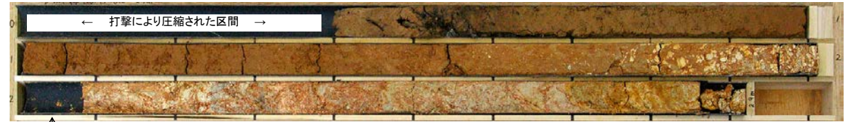
No.c コア写真 打撃により圧縮された区間
