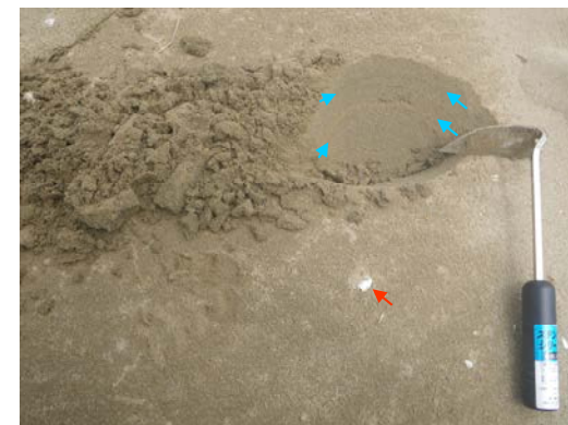
試料採取位置 (近接) ← 層理 ・砂層中に弱い層理が認められる → 貝殻片 ・堆積物中に貝殻片を含む
