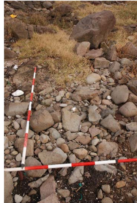
敷地前面海岸(C地点) 礫形調査位置 ・亜円～亜角礫主体で円礫も混じる
