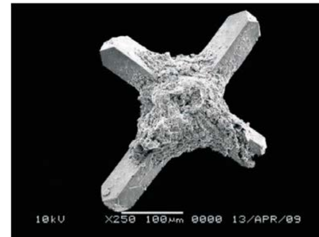
十字状の形態をなすフィリップサイトのSEM画像 (Adisaputra and Kusnida,2010)
