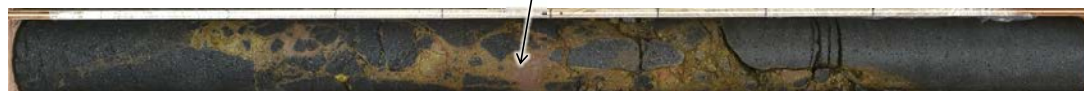
母岩中の割れ目に沿って粘土鉱物脈が認められる事例 (試料d. H-6.5-2孔 深度81.90m付近)
