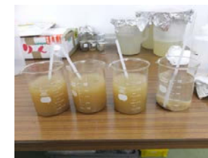
ビーカーを用いた水簸の例
