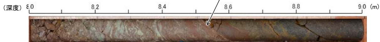
破砕部中に粘土鉱物が認められる事例 (試料D, E-8.5-2孔 深度8.55m付近)
