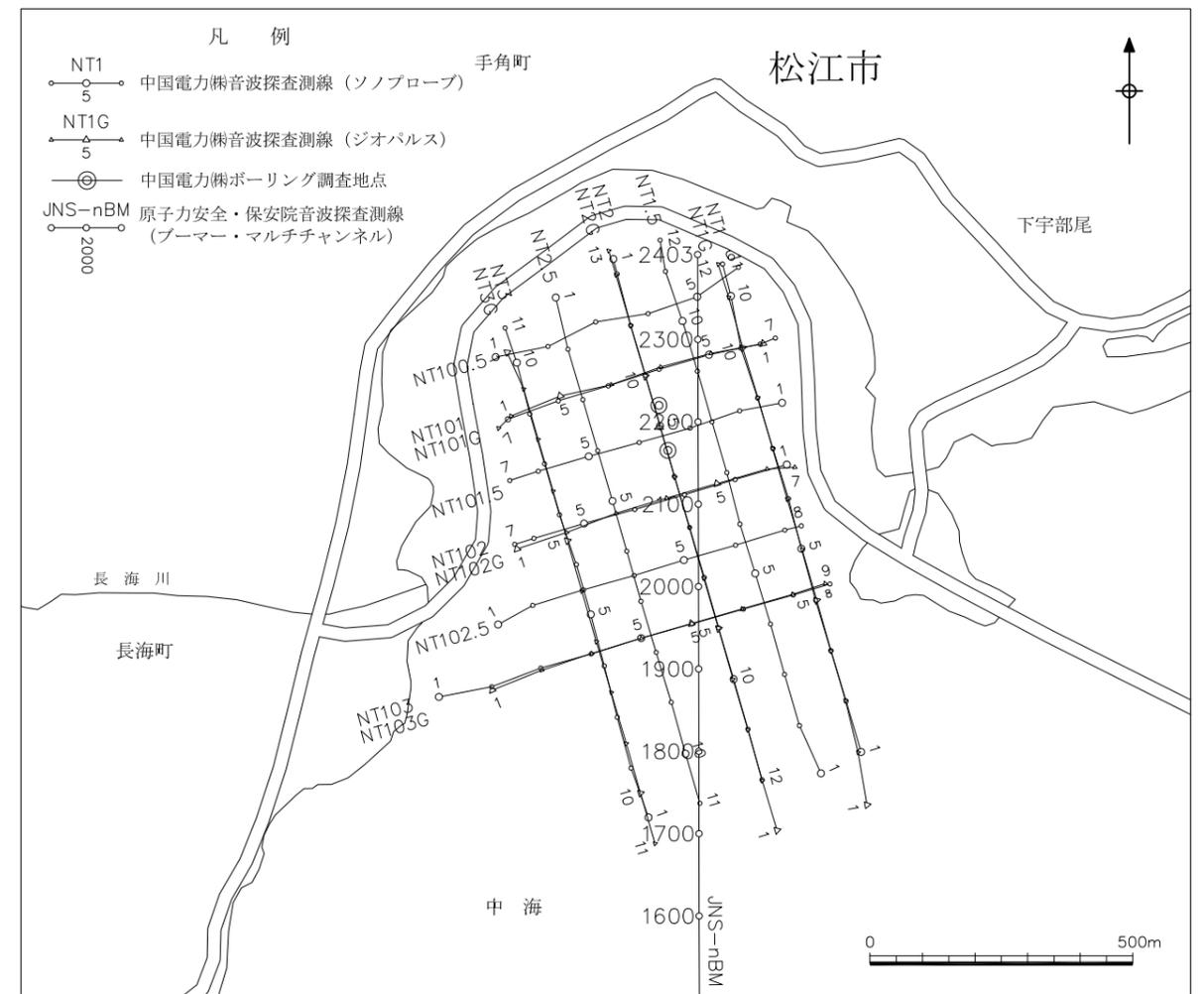
第3.3-44図 中海北部海域の音波探査測線図
