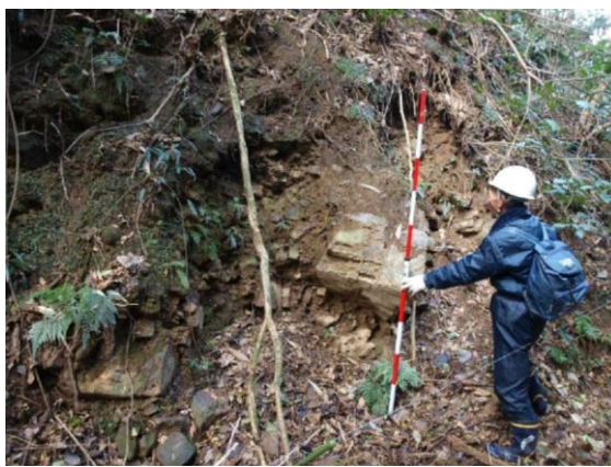
地すべり末端部には土砂が露出している
