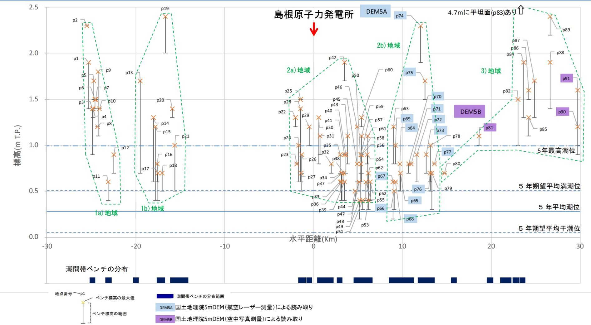
・区分されたいずれの地域にも、「潮間帯ベンチ」と「潮間帯より上位のベンチ」がともに発達しているが、潮間帯より上位のベンチは、標高2.5m以下の多様な高度で平坦面が形成され、定高性や系統的な高度変化などの規則性は認められない。
