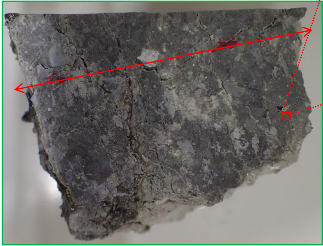
断層面を下から撮影 矢印は水平方向
