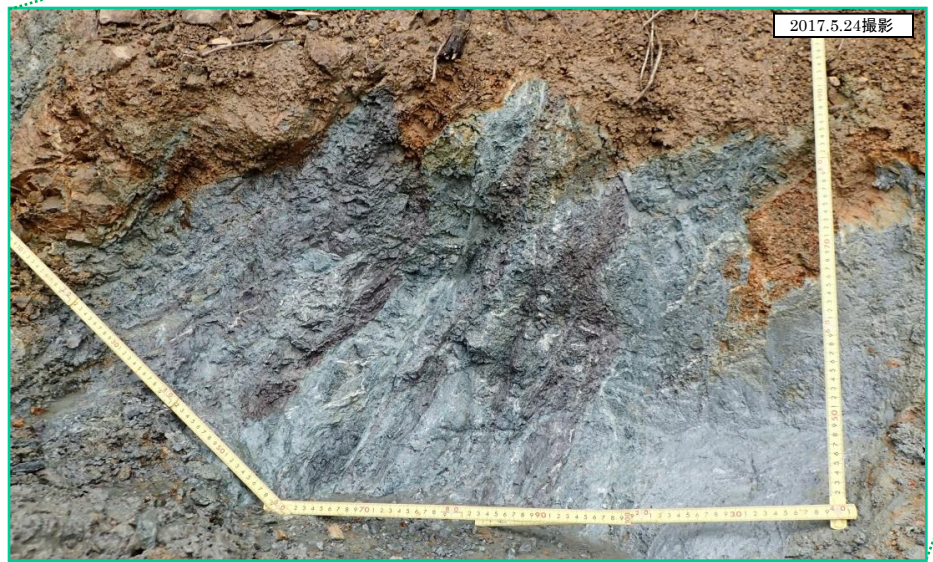
熱水変質部拡大(解釈線なし)
