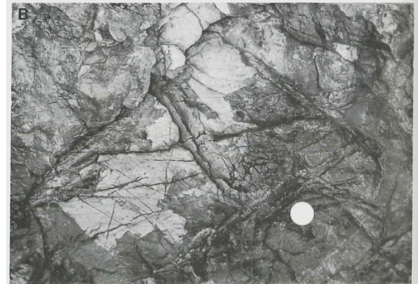
図X.3-11 水圧破碎による不規則な角礫状破碎組織
