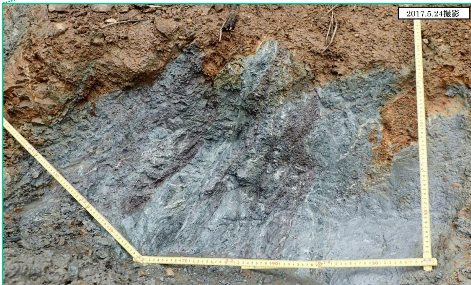
熱水変質部拡大(解釈線なし)
