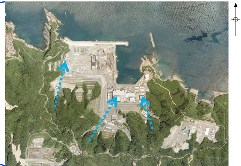
図 発電所周辺の主な地表水の流れ
