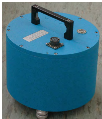
地震計LE-3D/5S レナーツ社 (独) http://www.lennartz-electronic.de/
