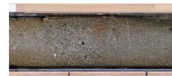
写真② M1 段丘堆積物は境界付近では10~15cm間隔で、細砂と礫混じり細砂が互層する。
