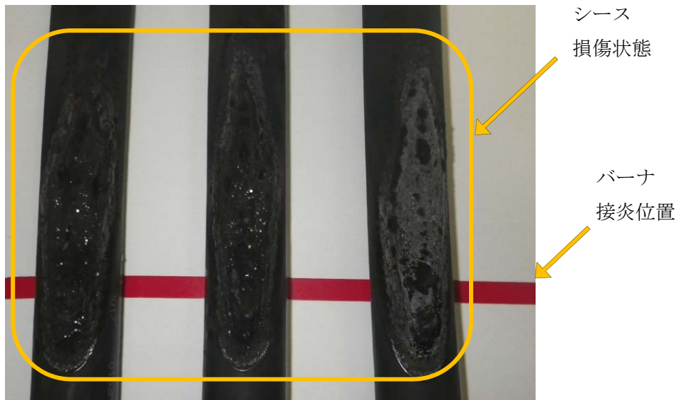
第2図 制御ケーブルの UL 垂直燃焼試験後の状態
