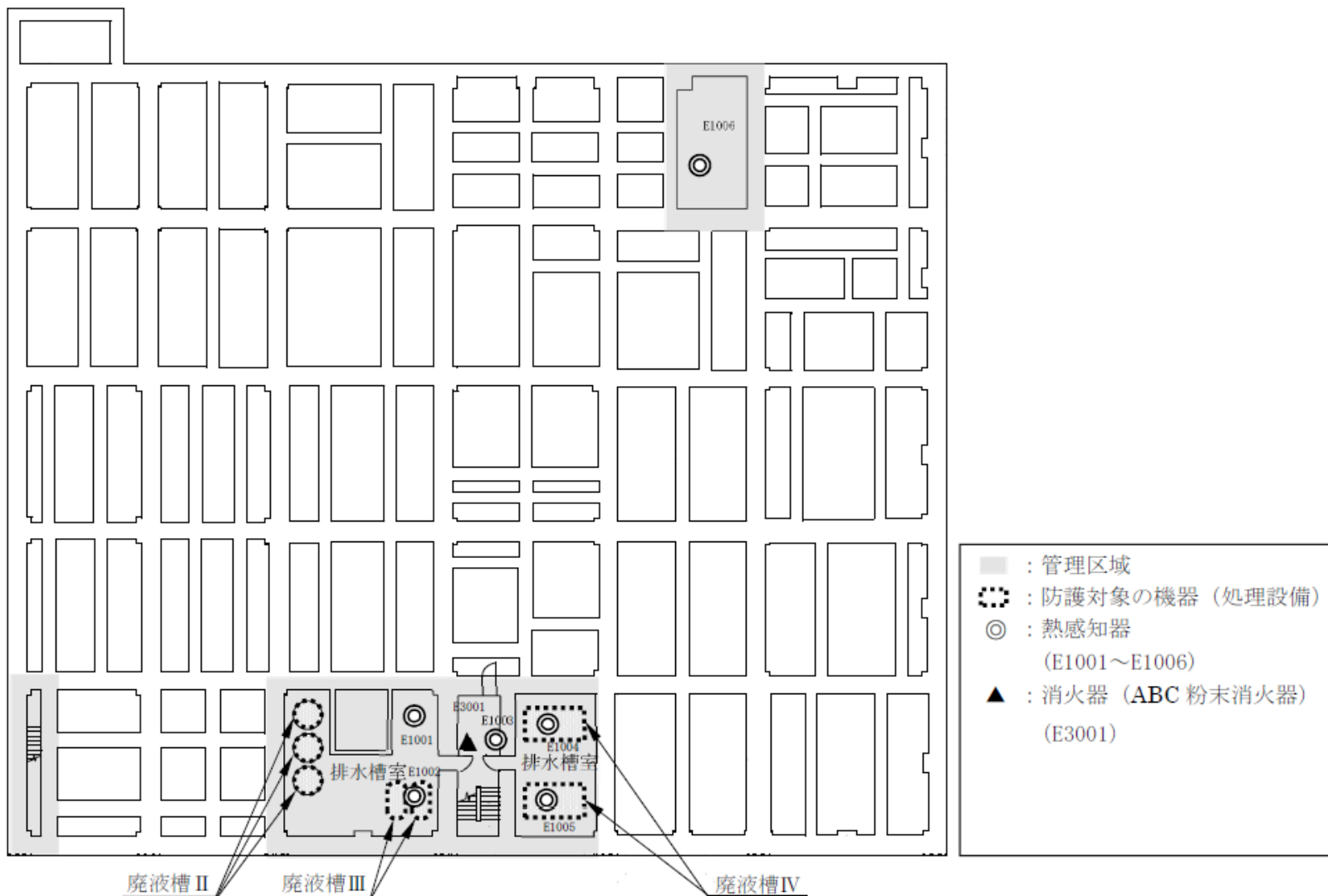
減容処理棟における火災感知設備及び消火設備の設置場所(基礎スラブ階)
