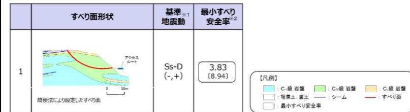
第 6.7-3 図 対策工（切取）を実施した斜面のすべり安定性評価結果
