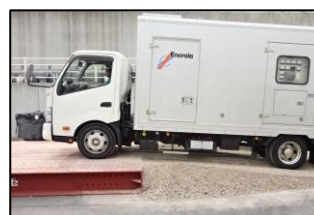
第 4 図 段差 40 cm復旧後の走行性能検証（1 / 2）
