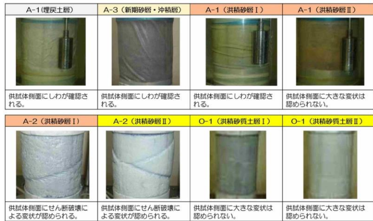
第11-4-16 図 液状化試験後の供試体状況
