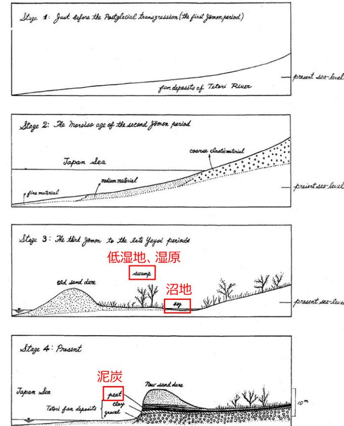
第8図 砂丘中に見られる埋積腐植土層の生因と形成過程を示す図
