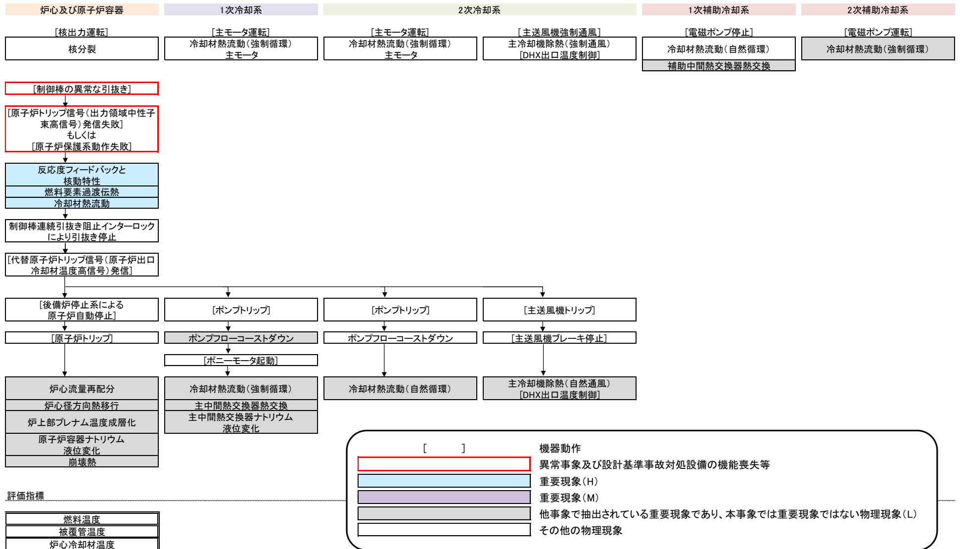
第2図 UTOP の炉心損傷防止措置時の事象進展チャート
