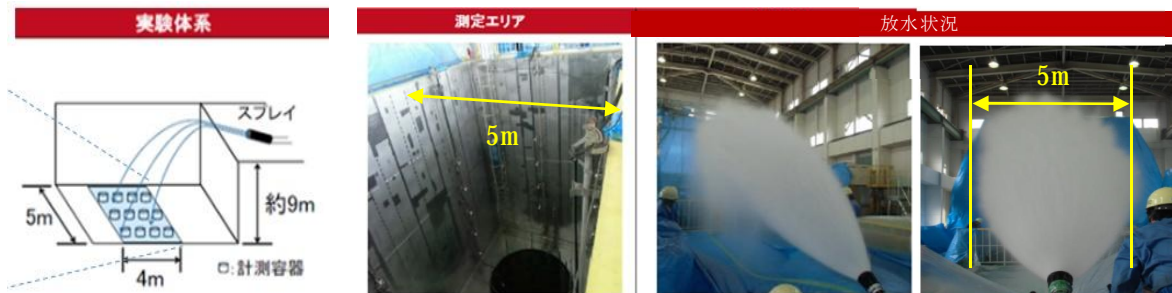
第1図 液滴径測定試験 試験体系および試験の様子
