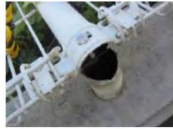
支柱部の破断
