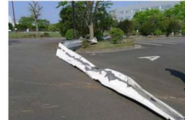
飛散した鋼板製屋根材
