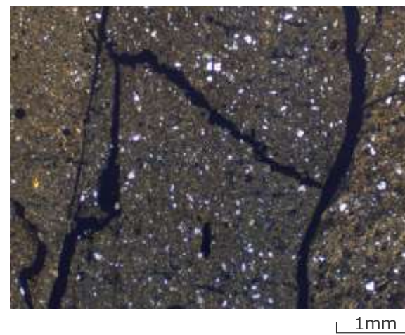
<薄片写真B部分の鏡下写真（左：単ニコル，右：直交ニコル）>
