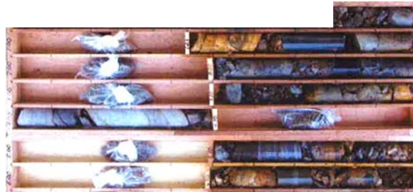
1, 2号炉建設時の埋戻土 ボーリングNo. P11 0.8m~7.0m
