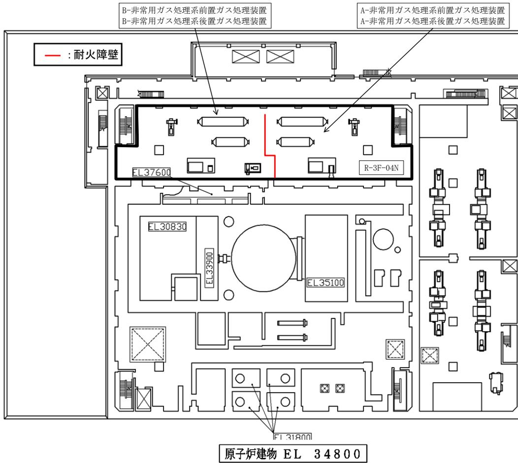
第 6-3-5 図 島根原子力発電所 2 号炉 上位クラス施設と耐火障壁の位置関係概要図 (2/3)
