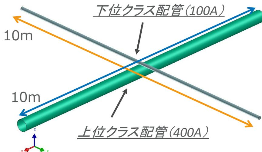
図 3.4-2 配管モデル概要
