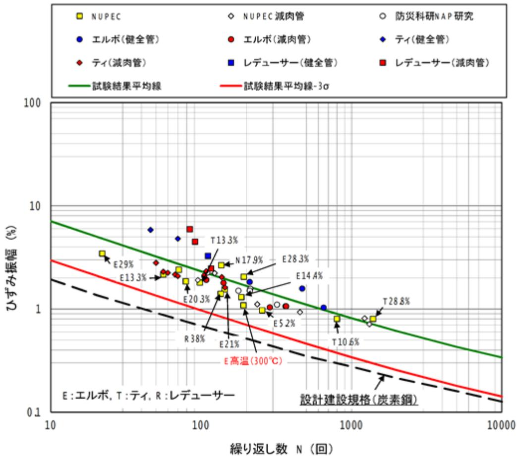
\* 図中の記号は、E：エルボ、T：ティ、R：レデューサ。パーセントで表された数値は、ラチェットひずみ（残留ひずみ）を示す。
