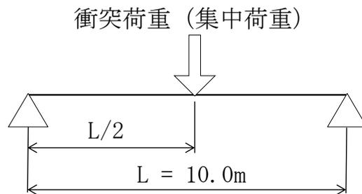
図 3.4-5 応力算出モデル
