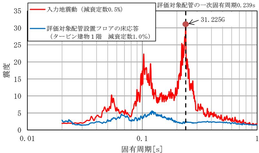
図 2.2-1 加速度応答スペクトル
