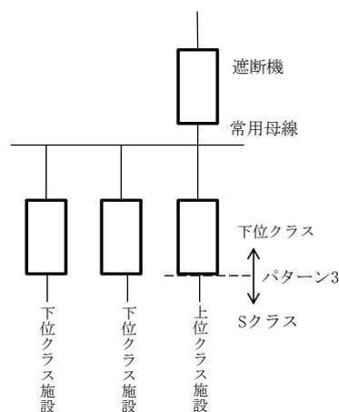
第5-2-2図 受電系統概念図（パターン1，2以外）
