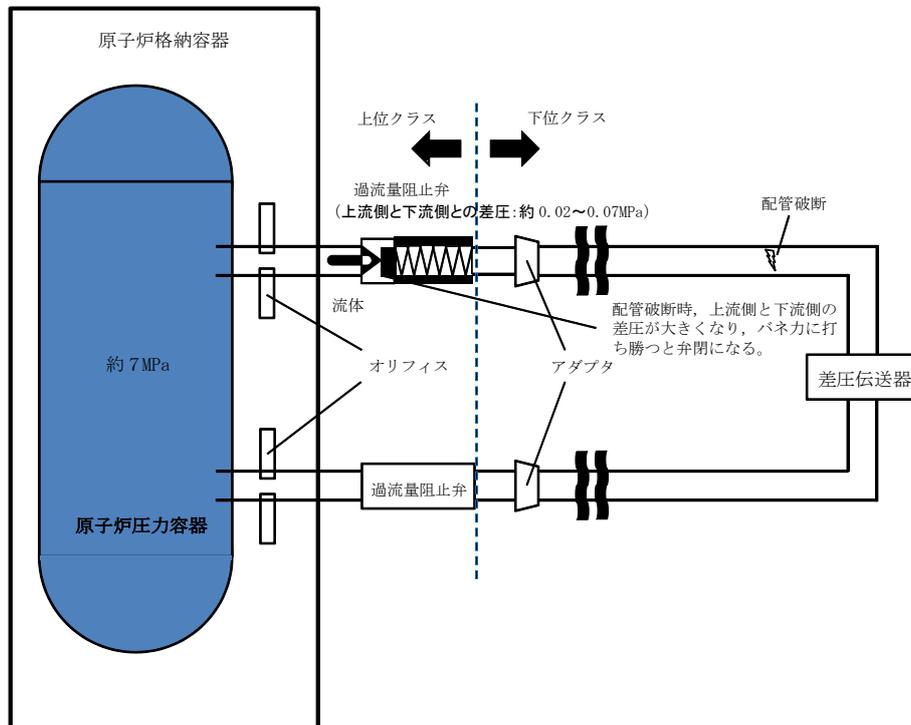
第 5-2-5 図 原子炉圧力容器からの計装ライン構成概念図
