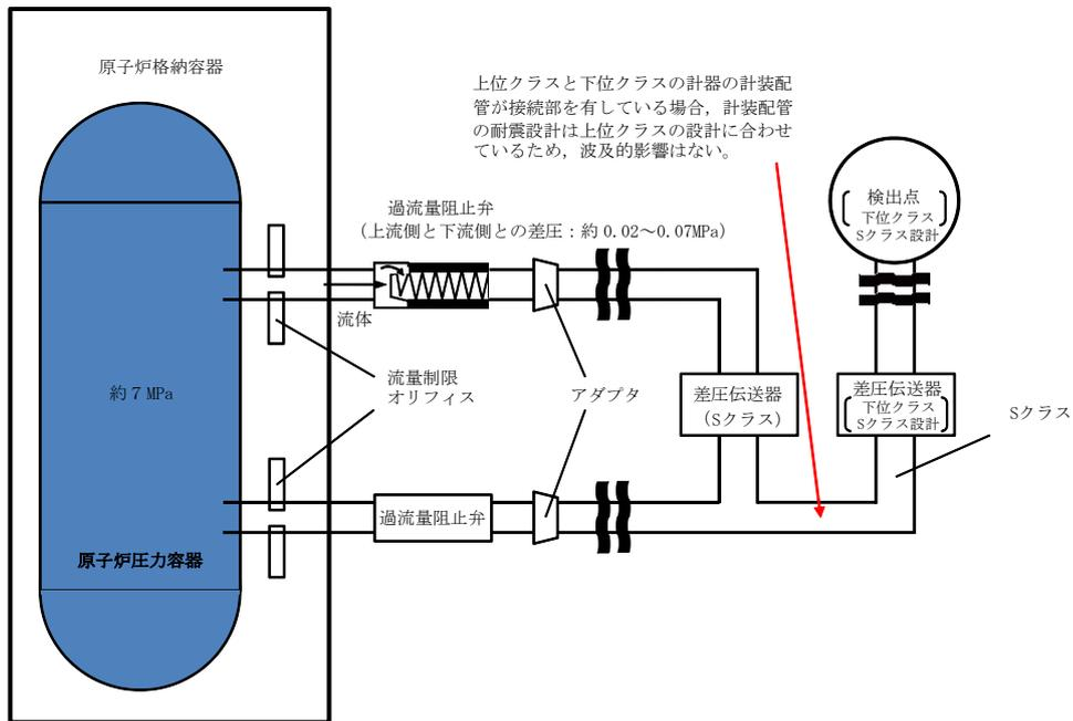
第5-2-4図 計装配管の耐震設計概念図
