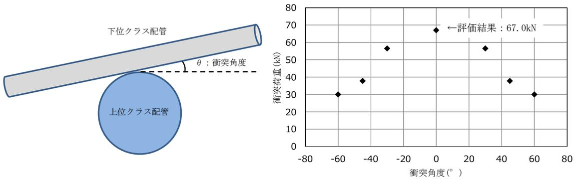
図 3.4-4 衝突角度と衝突荷重の関係
