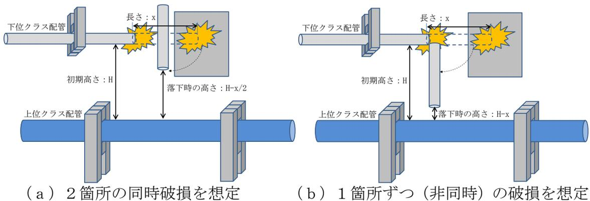
図 3.3-1 配管破損形態の想定と落下高さの設定
