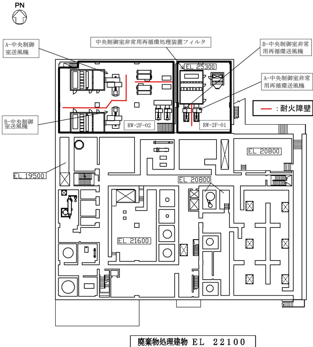
第 6-3-5 図 島根原子力発電所 2 号炉 上位クラス施設と耐火障壁の位置関係概要図 (3/3)
