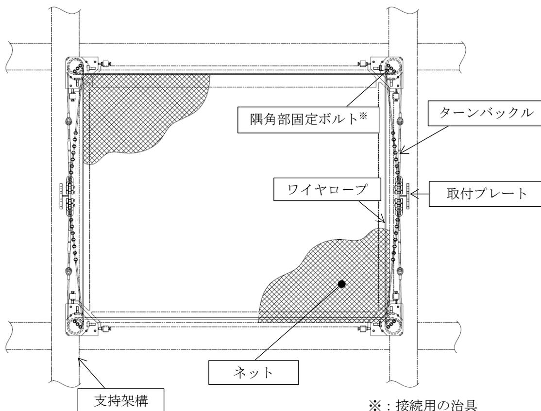
図1-1 飛来物防護ネット概要図
