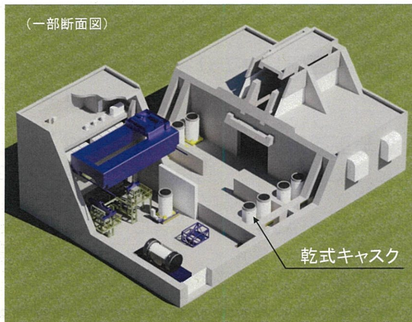
使用済燃料乾式貯蔵建屋 鳥瞰図 (乾式キャスク15基貯蔵の場合)
