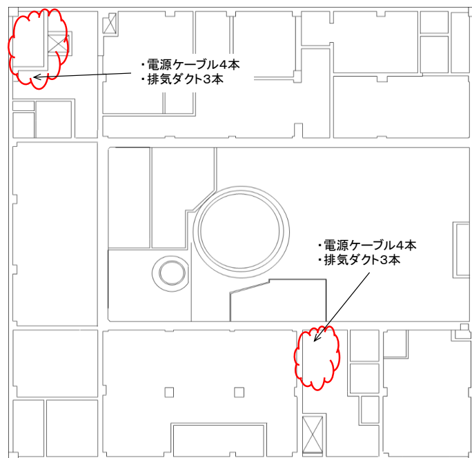
第 3.4 図 電源ケーブル、排気ダクトの 保管場所（原子炉建家 1 階）
